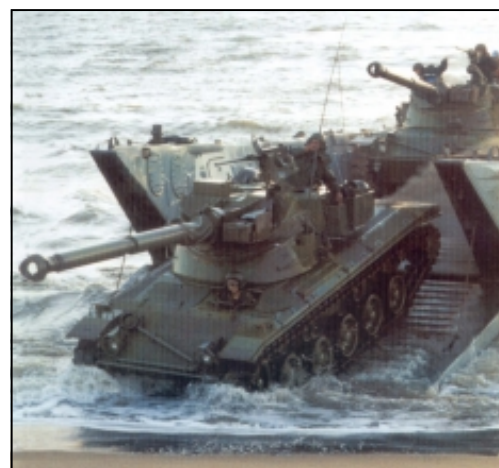
Carro de Combate SK 105 A2S. Peso: 18,600 kg, Tripulação: 3, Autonomia: 500 km, Velocidade Máxima: 70 km/h, Armamento Principal: Canhão 105 mm
